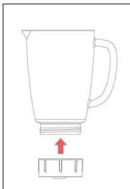
4. Placér glaskanden med knivholderen på motorenheten. Håndtaget kan placeres i to positioner: enten til højre eller venstre.
